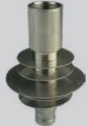
Refroidisseur avec embout de 14.5mm. Utilisé pour éloigner la tête des thermostats de la paroi dans des applications haute température. Se visse sur le filetage 3/8 BSPP sous le boîtier. Non compatible avec série Y0
