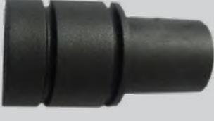
Embout clipsable en PA66 pour gaine annelée dia 10 mm, sortie pour traversée de paroi avec maintien du bulbe
