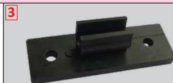
Clips de fixation sur paroi, PA66, base adhésive et possibilité de fixation par deux vis. Pour bulbes de 5 et 6mm. Température maxi 80°C
